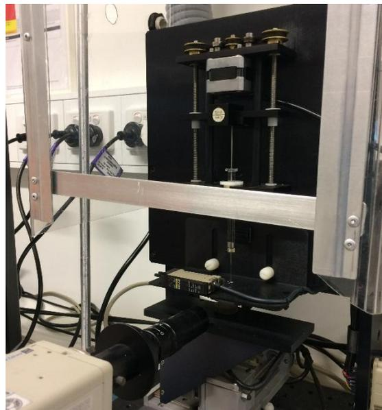
Fig. 3-6. FTA32 contact angle goniometer
